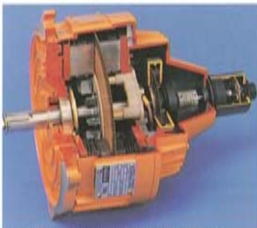
6 Motoren med skiverotor (kortmotor) har en kort, kompakt konstruksjon. Ankeret består av en belagt plastskive med liten masse
