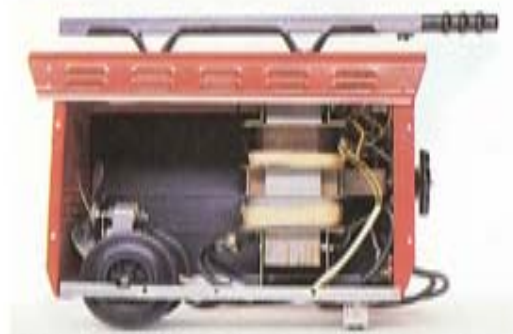
1 Dette sveiseanlegg har en sveisetransformator
