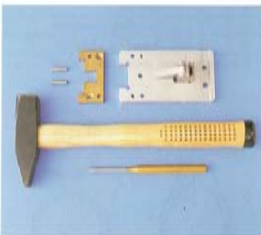
4 Montering av føringsplaten
