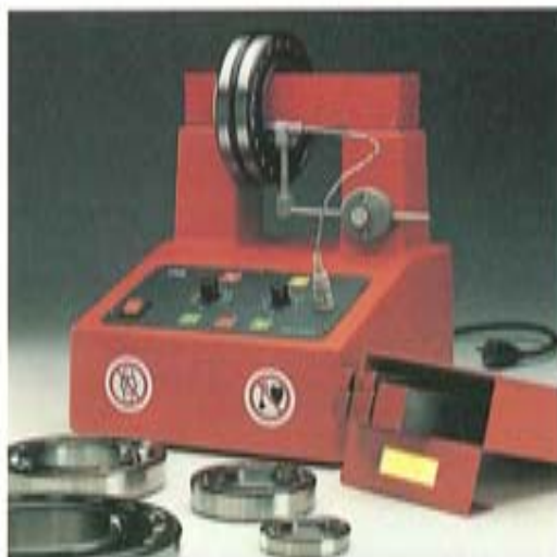
5 Oppvarming av et rullelager ved induksjon
