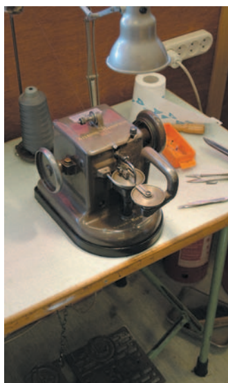
Buntmakerfagets spesielle symaskin, pelsmaskinen, ble oppfunnet i 1880-årene, og har ikke forandret seg så mye siden. Pelsmaskinen skiller seg fra andre symaskiner ved at nåla går vannrett og ved at den syr med én tråd
