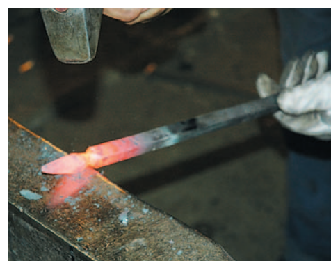
Først må emnet varmes opp i essen så det blir formbart, deretter hamres og formes det på ambolten. I løpet av arbeidet må emnet varmes opp flere ganger.
