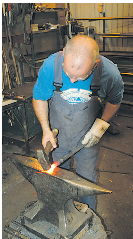
Først må emnet varmes opp i essen så det blir formbart, deretter hamres og formes det på ambolten. I løpet av arbeidet må emnet varmes opp flere ganger.
